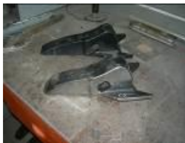
Рис. 1. – Вид нового и изношенного наконечника
