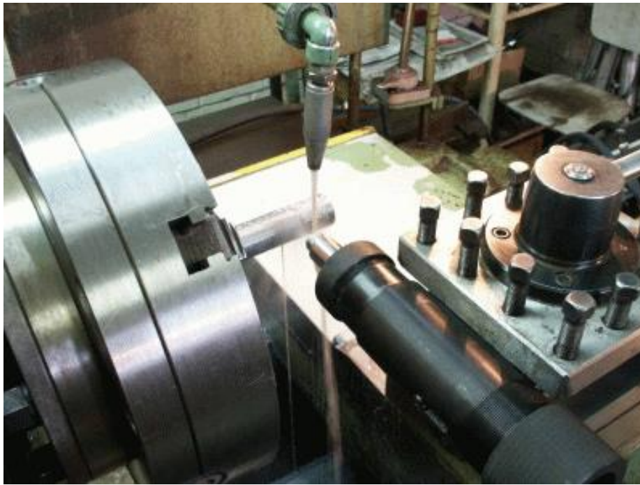
Рис. 1 – Ультразвуковая импульсная упрочняюще-чистовая обработка внешней поверхности тел вращения на токарном станке
