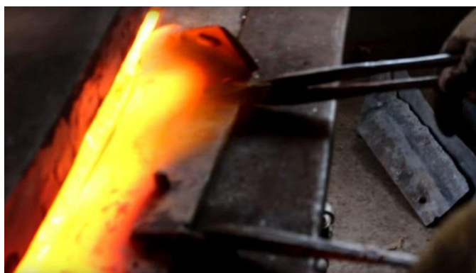
Рис. 3 – Восстановление лемеха кузнечной оттяжкой
