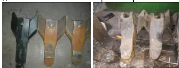
Рис. 5. – Вид изношенных наконечников после второго и третьего восстановления
