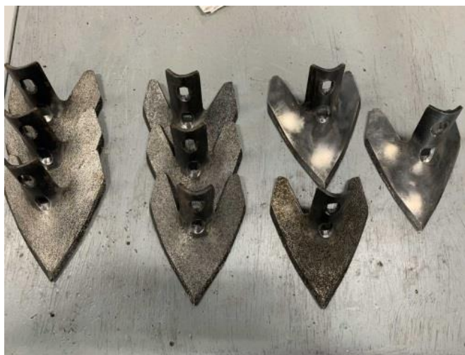
Рис. 2 – Слой электроискровой наплавки
