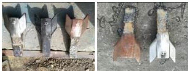
Рис. 4. – Вид наконечника после второго и третьего восстановления
