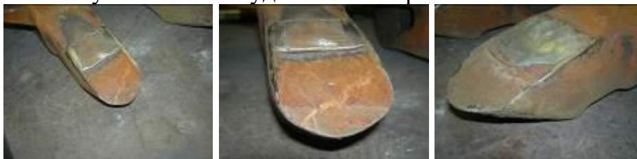
Рис. – 3. Изменение характера износа наконечника
